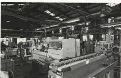
一貫生産が強みの横芝工場（手前が押出成形機、奥が円筒研削盤）
